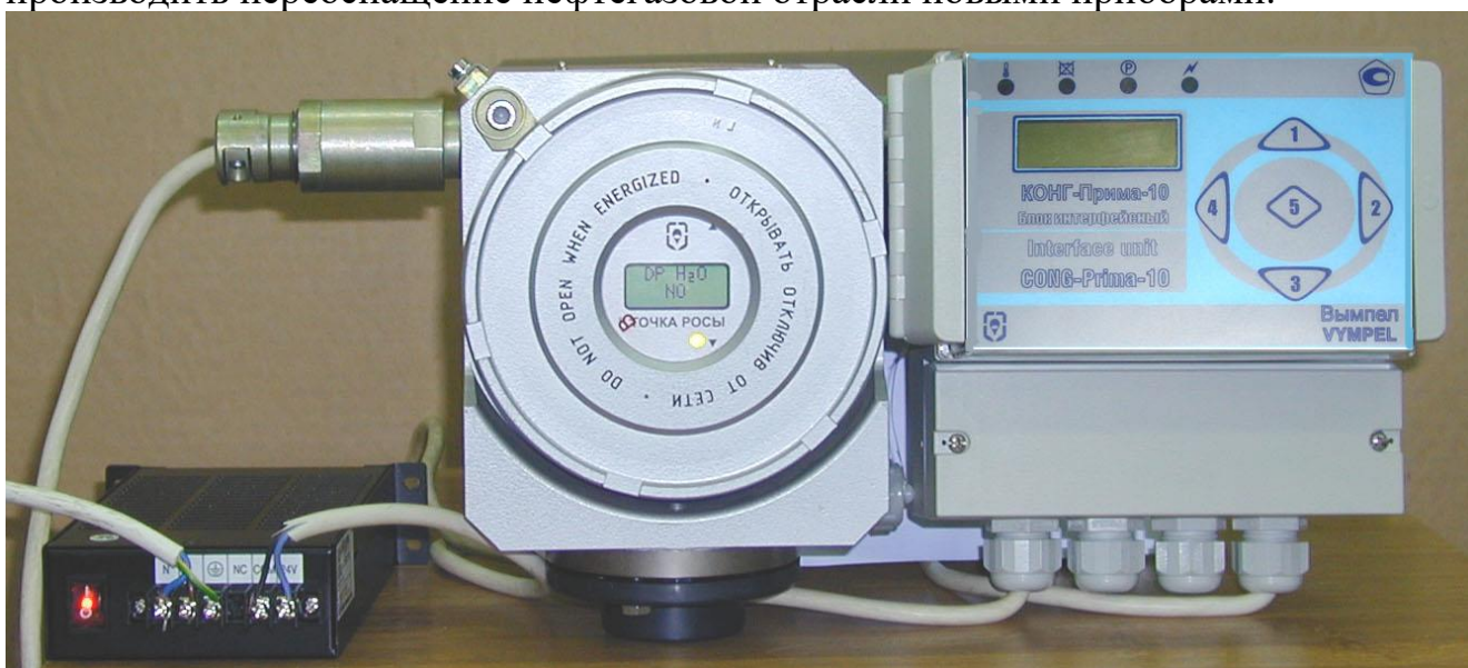
Рисунок 1. - Внешний вид Анализатора «КОНГ-Прима-10» (слева-направо: блок питания, преобразователь точки росы, интерфейсный блок)
