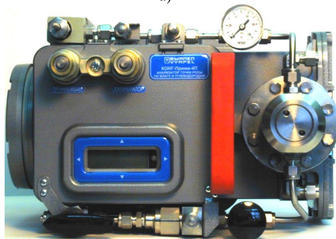
Рисунок 1 – Внешний вид анализатора точки росы «КОНГ-Прима-4П» а) вид сбоку; б) вид сверху
